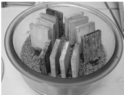
Рис. 3. Образцы термодревесины и контрольные образцы после проведения испытания на биостойкость по ГОСТ 30028.4-2006
