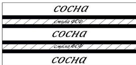
Рис.2. Модель пакета фанеры из модифицированного шпона
