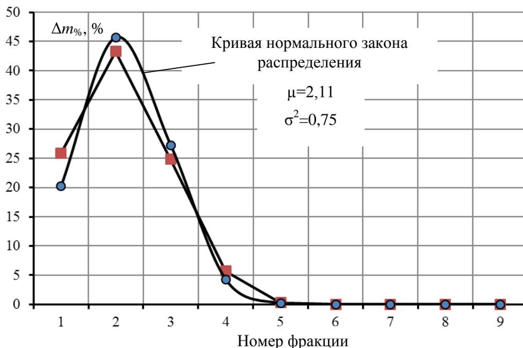
Рис. 5 – Кривая распределения размеров частиц стружки, полученной при встречном фрезеровании ДСтП однолезвийной прямозубой хвостовой фрезой  $\varnothing 21$  мм, при толщине снимаемого слоя 5 мм, частоте вращения фрезы  $16000 \text{ мин}^{-1}$ , подаче на зуб 0,1 мм и соответствующая кривая нормального закона распределения
