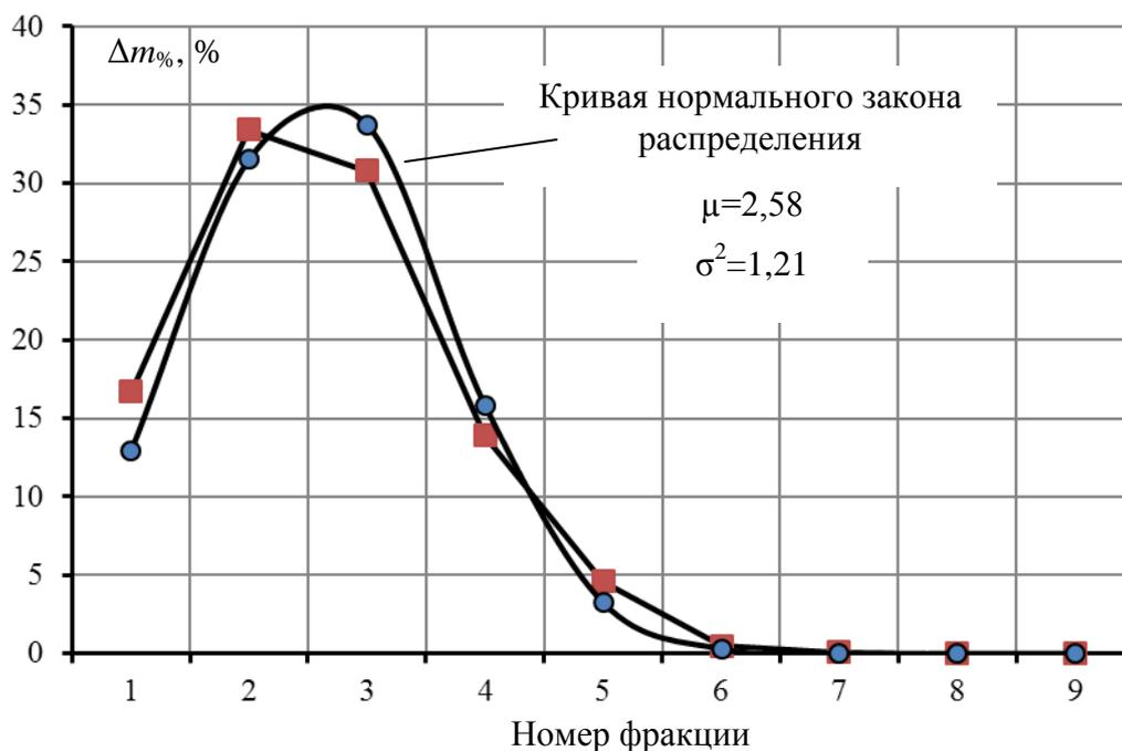
Рис. 4 – Кривая распределения размеров частиц стружки, полученной при встречном фрезеровании ДСтП однолезвийной прямозубой хвостовой фрезой  $\varnothing 21$  мм, при толщине снимаемого слоя 5 мм, частоте вращения фрезы  $16000 \text{ мин}^{-1}$ , подаче на зуб 0,1 мм и соответствующая кривая нормального закона распределения
