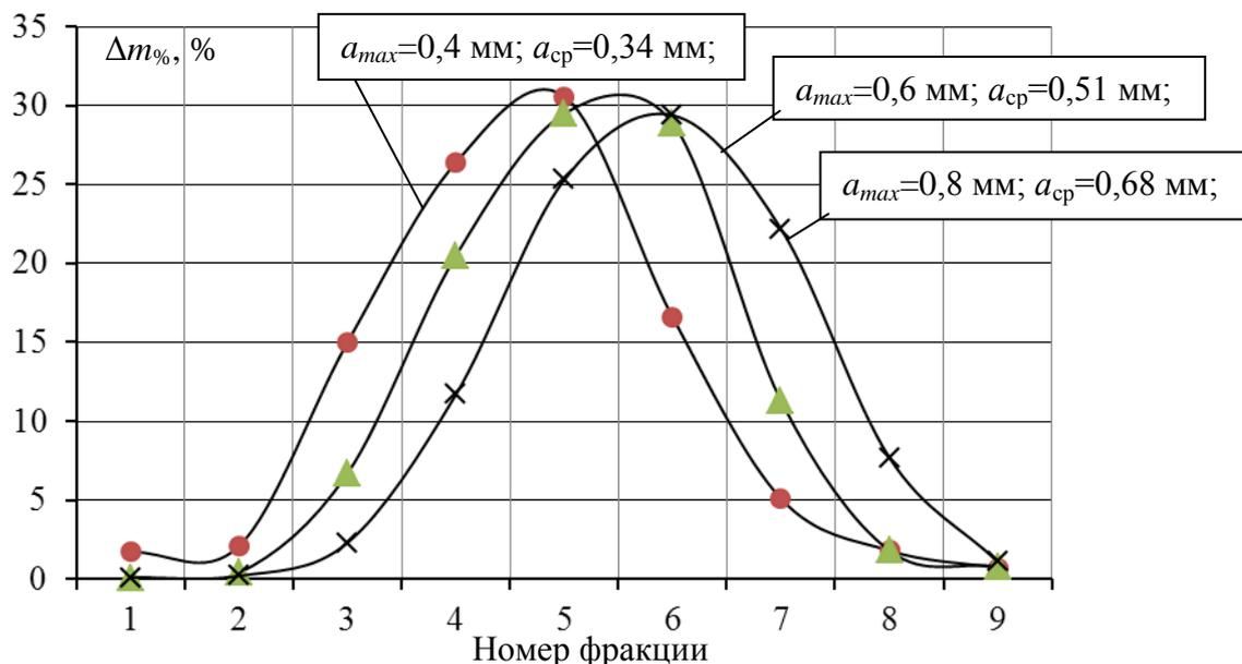
Рис. 3 – Кривые распределения размеров частиц стружки, полученной при различных режимах встречного фрезерования ДСтП однолезвийной прямозубой хвостовой фрезой  $\varnothing 21$  мм, при толщине снимаемого слоя 5 мм, частоте вращения фрезы  $16000 \text{ мин}^{-1}$
