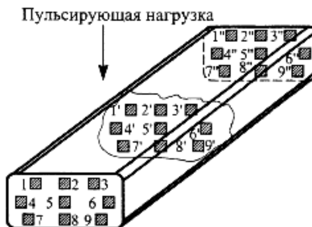
Рис. 1. Схема выпиливания образцов из шпалы для динамических испытаний
