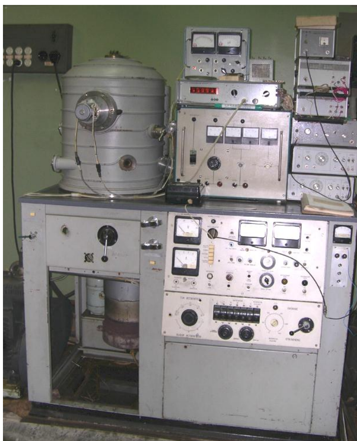
Рис. 2. Установка ионно-лучевого модифицирования
