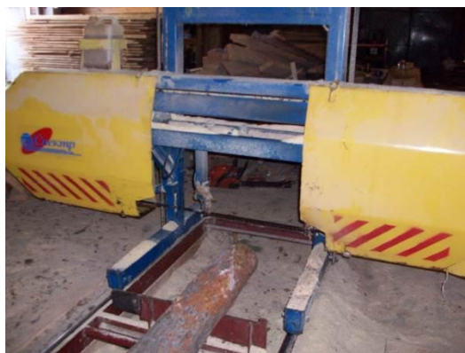
Рис. 8. Двухстоечный ленточнопильный станок «Спектр» СРЗ 200-04 С для исследования энергетических и качественных показателей процесса пиления мягколиственной древесины
