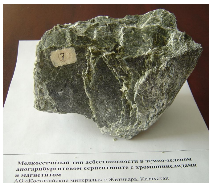
Рис. 3. Мелкосетчатый тип асбестонности в темно-зеленом апогарцбургитовом серпентините с хромшпинелидами и магнетитом
