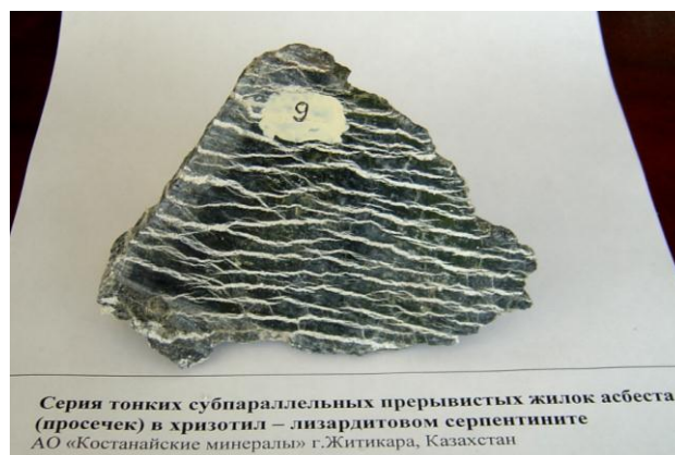
Рис. 4. Серия тонких субпараллельных прерывистых жилок асбеста в хризотил-лизардитовом серпентините
