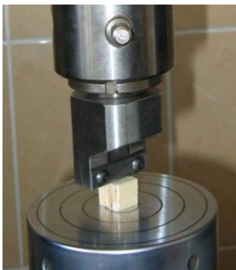
Рис. 7. Приспособление для крепления ножей
