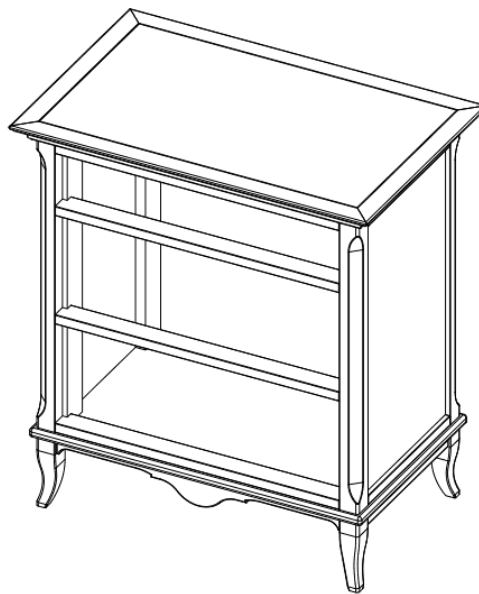
Рис. 2. Каркас комода, спроектированного в среде «Многотельная деталь»
