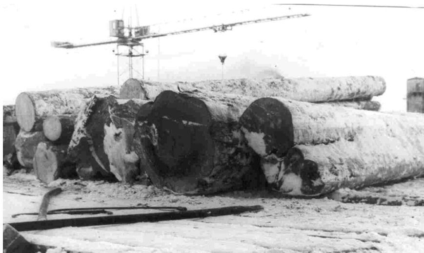
Рис. 2. Окорка древесины в зимнее время
