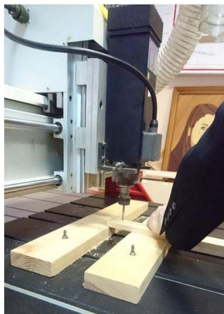
Рис. 2. Исследование качества отверстий на станке с ЧПУ на входе и выходе
