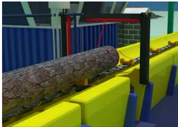
Рис. 3. Линия сортировки бревен с двухплоскостным сканером
