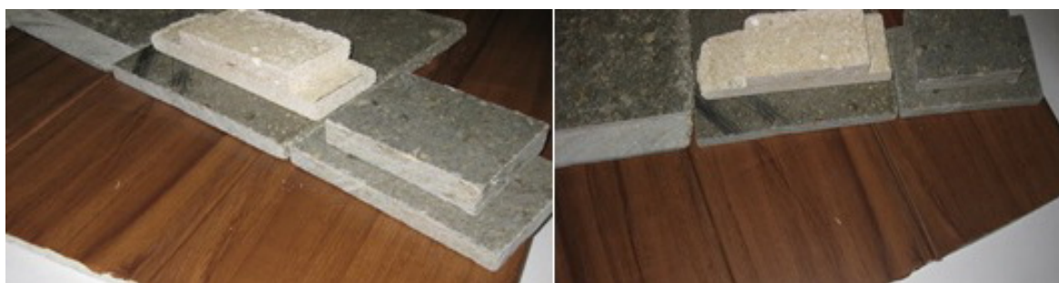
Изготовленные стеновые панели на основе материала «Плитотрен»
