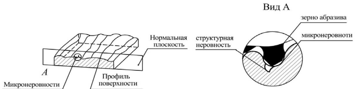
Рис. 1. Профиль поверхности древесины
