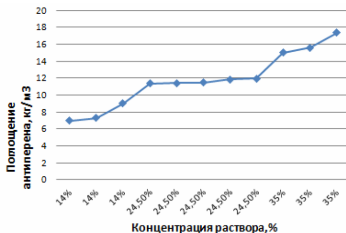
Рис. 3. Зависимость поглощения состава МПС от концентрации
