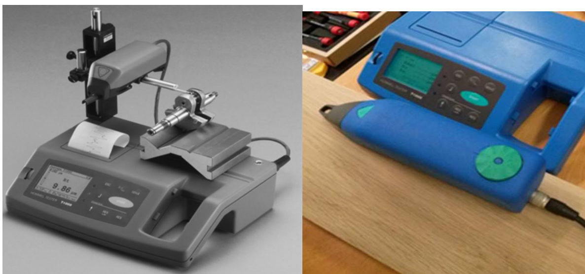
Рис. 2. Профилограф HOMMEL TESTER T1000 basic
