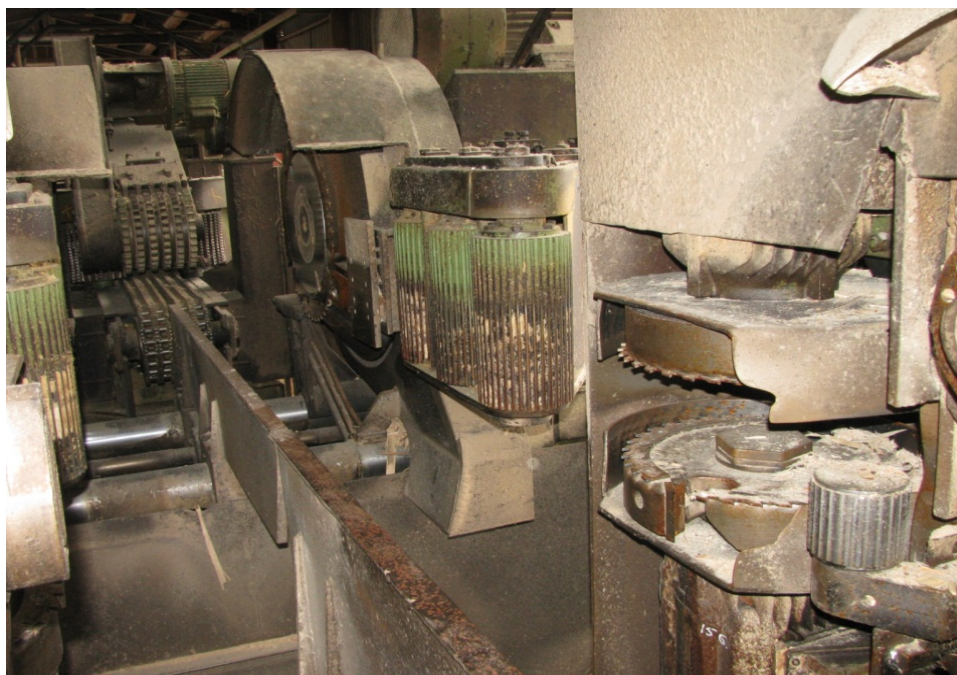
Рис. 2. Фрезерно-пильный станок VPS
