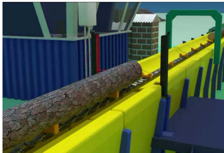
Рис. 2. Линия сортировки бревен с одноплоскостным сканером
