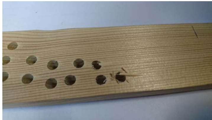
Рис. 3. Качество поверхности на выходе сверла из отверстий
