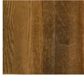
Рис. 3. Результат формирования лакокрасочного покрытия на щите из дуба при двухстадийном методе нанесения (краситель, патина)
