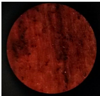
Рис. 4. Результат формирования лакокрасочного покрытия на щите из дуба при трехстадийном методе нанесения (краситель, лак, патина) с увеличением 140х
