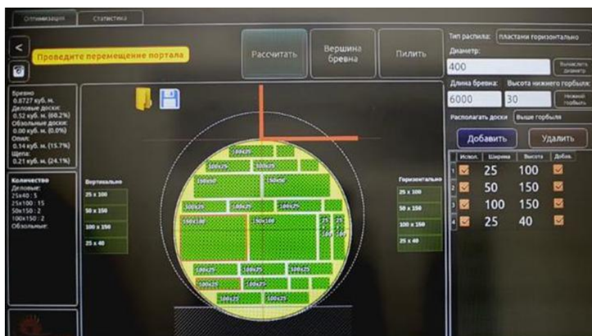
Рис. 5. Окно программы с оптимальным планом раскря бревна
