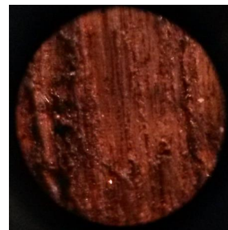
Рис. 5. Результат формирования лакокрасочного покрытия на щите из дуба при двухстадийном методе нанесения (краситель, патина) с увеличением 140х
