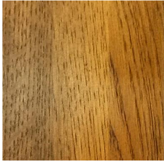
Рис. 2. Результат формирования лакокрасочного покрытия на щите из дуба при трехстадийном методе нанесения (краситель, лак, патина)
