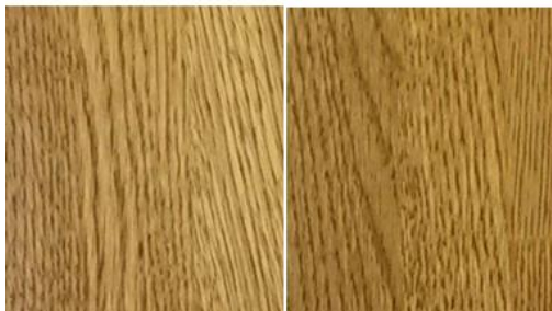
Рис. 6. Результат нанесения красителя KROMOROLLER (однослойное покрытие)
