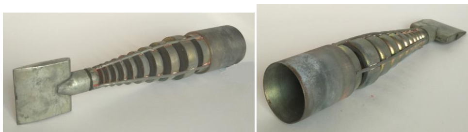
Рис. 3. Вид жалюзийной решетки пылеотделителя экспериментальной установки
