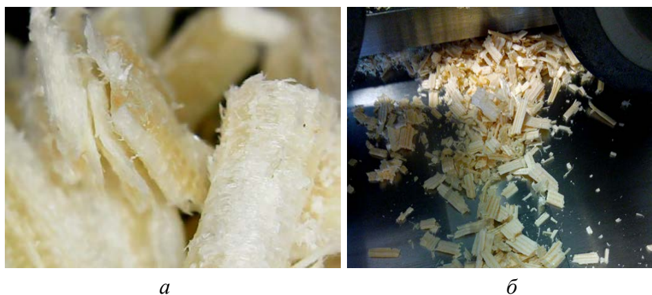
Рис. 4. Получаемая стружка: а – острым лезвием; б – лезвием, потерявшим режущую способность
