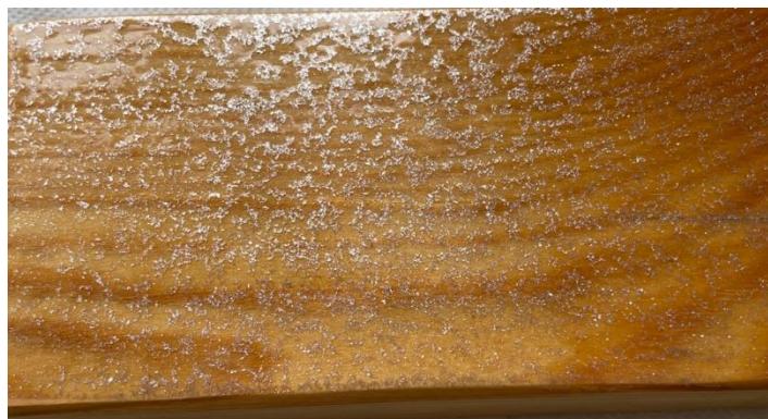
Рис. 4. ЗДП на основе эпоксидной смолы с добавлением серебристого пигмента
