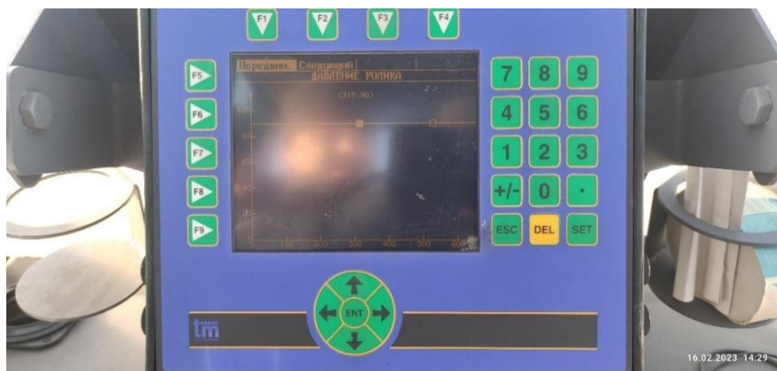
Рис. 3. Копия экрана настроек максимального давления протаскивающих валцов на измерительной системе Tech Measure 1000
