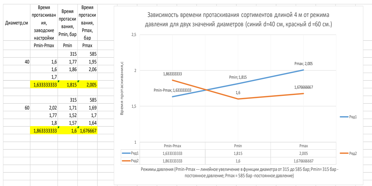
Рис. 4. Копия экрана обработки результатов эксперимента (желтым выделены средние значения по результатам трех повторов)
