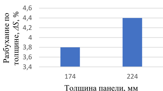
Рис. 5. Влияние толщины пенополистирола на разбухание по толщине СИП-панелей
