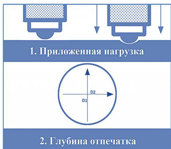
Рис. 1. Схема определения твердости по методу Бринелля
