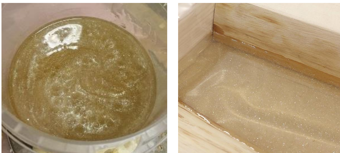
Рис. 4. Равномерное распределение желтого пигмента в структуре ЛКК и отвержденном слое
