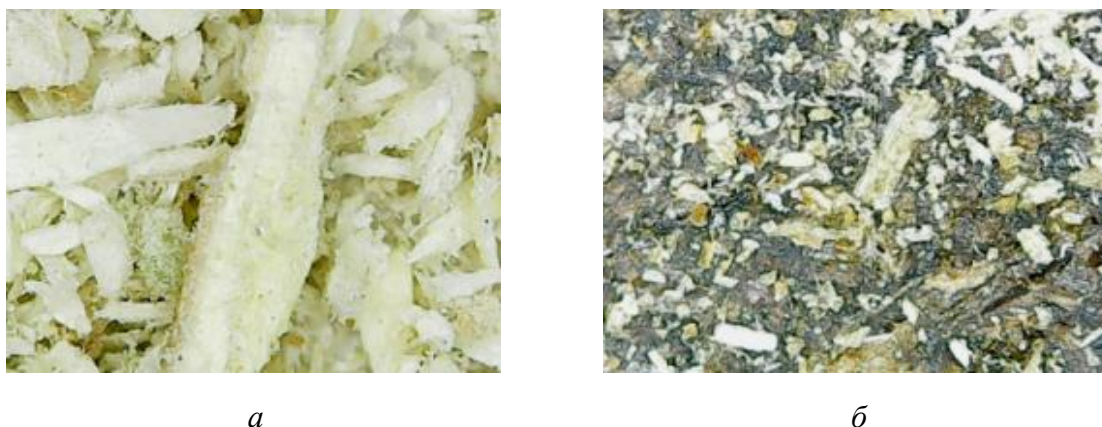
Рис. 1. Микрофотографии (1×400): а – исходного сырья; б – поверхности образцов ПБС
